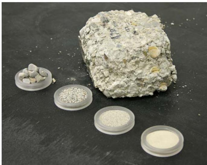
Vorher, nachher: Die Betonprobe, fein säuberlich in ihre Bestandteile getrennt. Die erhaltenen Kornfraktionen werden nach einer elektrodynamischen Fragmentierung getrocknet und gesiebt
