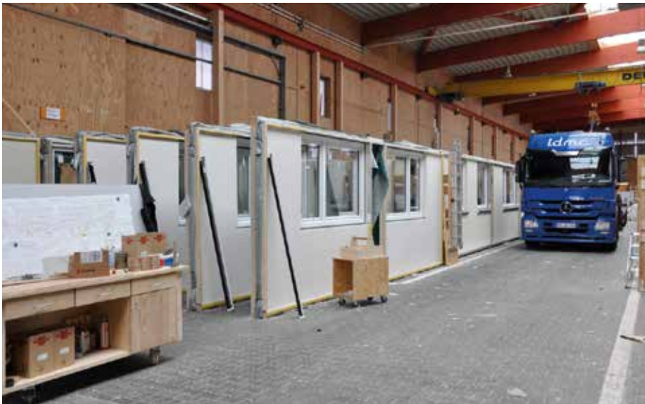
Fertig zum Abtransport: Die Elemente in Holztafelbauweise komplett mit eingebauten Fenstern, Anschlüssen und Leerrohren.
